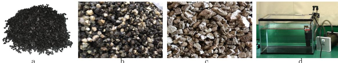
図1 浄化資材 (a:活性炭、b:無処理 Vm、c:焼成 Vm、) と実験装置 (循環区)
