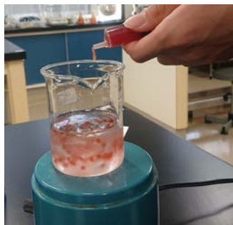
写真 7 スターラーで攪拌しながら塩化カルシウム水溶液に注射器で滴下する。
