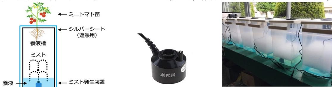
図 3 自作栽培装置(左：システム図 中：ミスト発生装置 右：ミスト発生装置)
