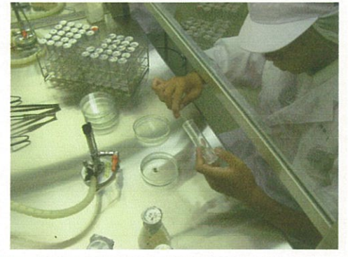
図7 塩分吸収量試験（無菌室）
