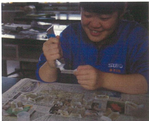
写真9 ボンドを塗った後に、砂につけることで、コーティングを施す。
